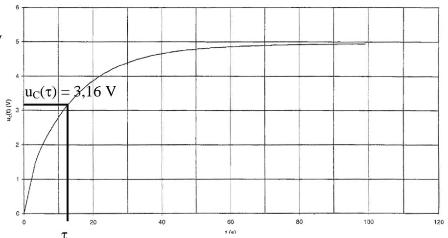
On obtient un écart relatif d'environ **20 %** avec la valeur donnée par le fabricant. Notre résultat est compatible avec l'indication du fabricant.
