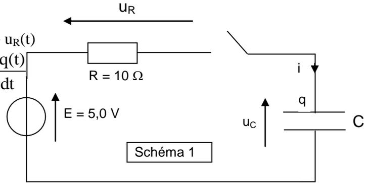
(0,5) Il vient :  $E = u_C(t) + R \cdot C \cdot \frac{du_C(t)}{dt}$  équation différentielle vérifiée par  $u_C(t)$ .
