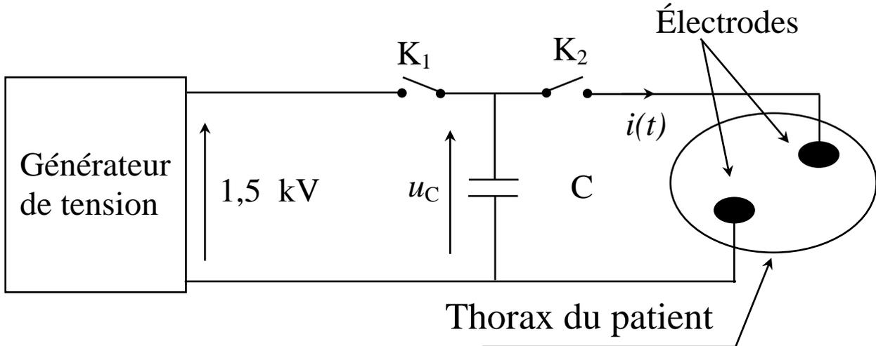
La capacité du condensateur  $C$  est de  $470 \mu F$ .
