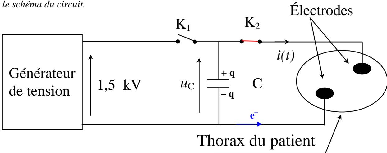
Les électrons accumulés sur l'armature portant la charge  $-q$ , vont (en l'absence de l'influence du générateur) rejoindre l'autre armature portant la charge  $+q$  en passant par le thorax du patient. La charge électrique  $+q$  diminue au fur et à mesure.
